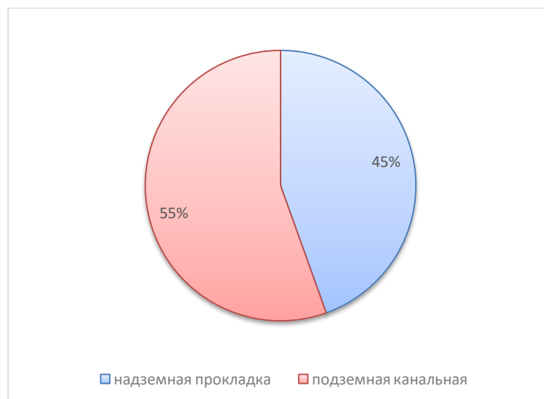
Рисунок 6 Структура теплосетей в зависимости от способа прокладки.
